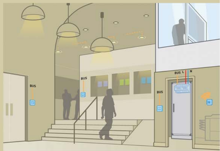
کلیدهای کنترل، کلیدهای با صفحه نمایش لمسی و کنترل از راه دور با استفاده از تکنولوژی باس به هم ارتباط دارند و همچنین قابلیت تکمیل سیستم با استفاده از فناوری زیبایی
