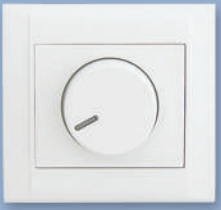
42001031 ŞEBEKE FİLTRELİ DİMMER TOROIDAL DIMMER Çalışma Aralığı / Power Range 60W-600W Akım / Rated Current 4A Koruma Derecesi / Protection IP20
