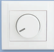
42001011 DİMMER DIMMER SWITCH Çalışma Aralığı / Power Range 60W-600W Akım / Rated Current 4A Koruma Derecesi / Protection IP20
